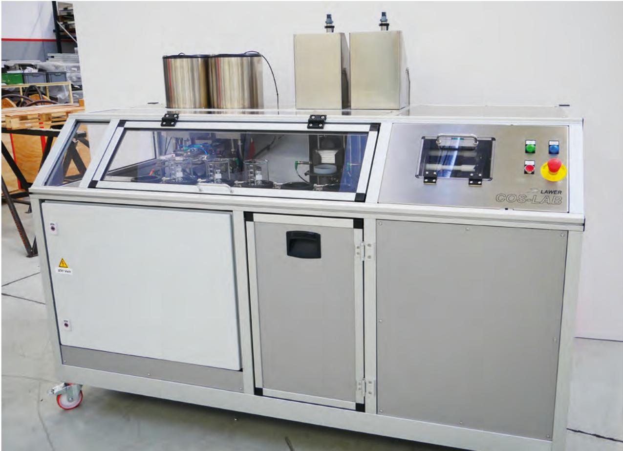
SUPERCOLOR ID-TAG è un sistema di pesatura completamente automatico, che consente una preparazione sicura e pulita di ricette in polvere.
